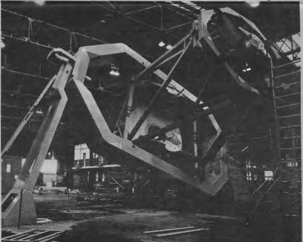
De 3,8 meter Infrarood Telescoop in aanbouw in de fabriek van Dunford Hadfields Ltd. Dit instrument zal door Engeland en Nederland in gebruik worden genomen op de 4200 meter hoge berg Manna Kea (Hawaii).
